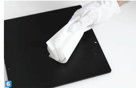
Retirer les dépôts de la plaque d'aluminium.
