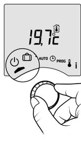
Ce mode permet de mettre votre installation de chauffage en arrêt. Tournez la molette sur .
