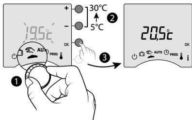
Ce mode permet de choisir une température de consigne (5 à 30°C) de façon permanente. Ce réglage peut être limité (menu 2-01 = 1).
