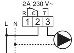
Th Commande de l'entrée thermostat / Bedienung thermostaatgang / Steuerung des Thermostateingangs / Comando dell'ingresso termostato / Thermostat input control
