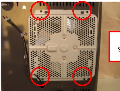
DEVISSER LES 4 VIS DE FIXATION SITUÉES À L'ARRIÈRE DE L'APPAREIL
